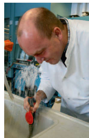
Skylning med fastmonteret øjenbruser. Ofte hurtigste førstehjælp med ubegrænset mængder af vand.
