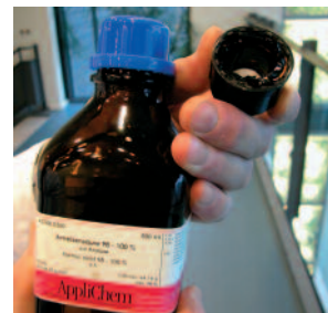
Flasken, som eksploderede på FARMA, var kun ét år gammel. En identisk flaske ses til venstre. Til højre ses skruelåget fra den eksploderede flaske – bemærk glasresterne.
