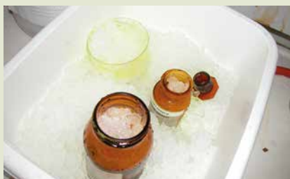
Befugtning af formodet tør picrinsyre inden bortskaffelse.
