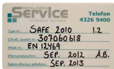
Eksempel på servicemærkat på mikrobiologisk sikkerhedskabinet klasse II med kontrol efter DS/EN 12469.
