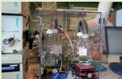
Indkapslinger – her plastkasse forsynet med låge og sug – forhindrer spredning af forureninger bedre end almindelige punktsug.
