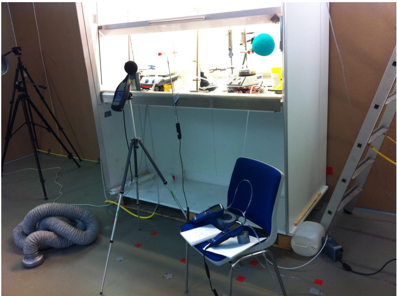
Figur 6 – Opstilling til støjmåling. Lydmåleren står på trefoden centreret foran stinkskabet.
