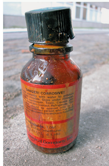
Eksempel på emballage med ødelagt skruelæg
