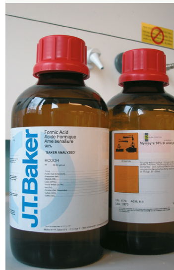
Leverandøren af disse flasker dokumenterede, at skruelåget var forsynet med sikkerhedsventil. Dermed overholdt emballagen myndighedskravene, men sikkerheden er ikke synliggjort for brugerne
