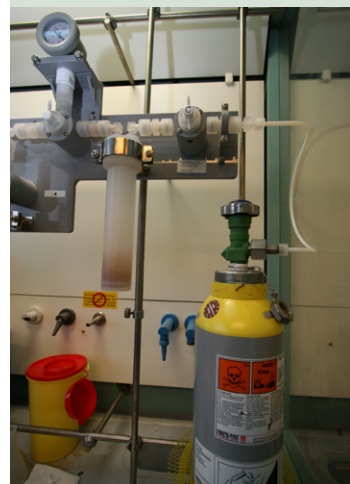
Mindre trykflasker med specialgasser anvendes ofte i laboratoriet. Her er en opstilling tilsluttet hydrogenfluorid placeret i stinkstab
