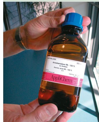
Koncentreret myresyre i glas- emballage uden sikkerheds- ventil
