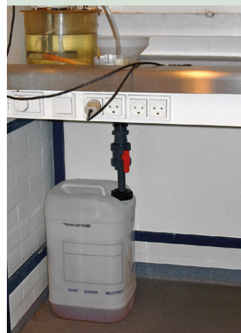
Dunk til kemikalieaffald med forbindelse gennem stinkskabsbund. Dunken burde stå på spildbakke
