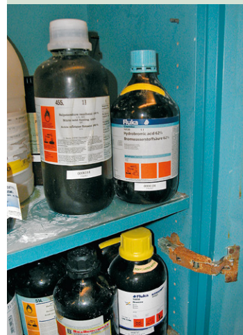
Stærkt ætsende kemikalier korroderer metallhængsler i opbevaringsskabe
