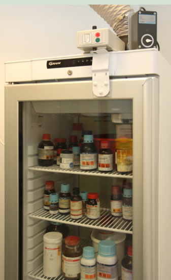
Køleskab indrettet med sug, der aktiveres inden åbning af lågen
