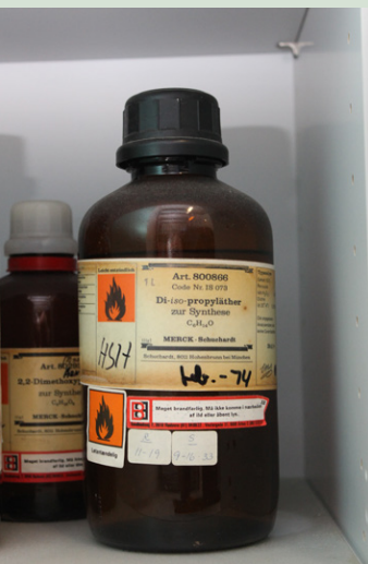
Diisopropylether kan danne det primære sprængstof triacetonetriperoxid (TATP). Den viste 40 år gamle flaske blev fjernet af et ammunitionsrydningsfirma
