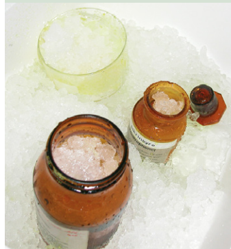
Befugtning af små mængder picrinsyre med formodet vandindhold under 10 %
